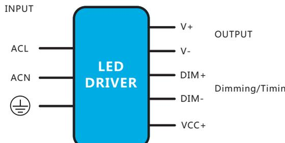
**AC 输入线(外露长度450±10mm) :**
